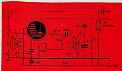
Voorzetapparaat met aperiodische ingangskring en idem uitgangskring
