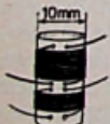
Eigengemaakt kortegolfspoeltje met een diam. van 10 mm. Let op de gaatjes voor de bevestiging van de draadjes
